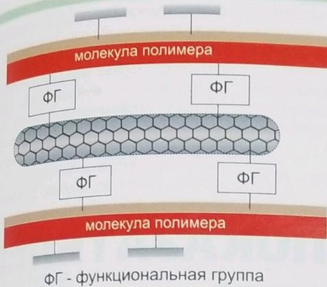
Рис. 1 – Схематическое изображение текстильных волокон, встроенных между молекулами полимера, соединённых с ними с помощью функциональных групп
